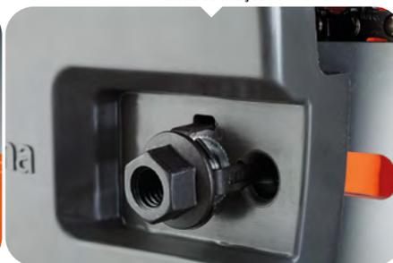
Ilhó duplo (proporciona uma forma segura de ligação entre a motosserra e a correia de fixação)
