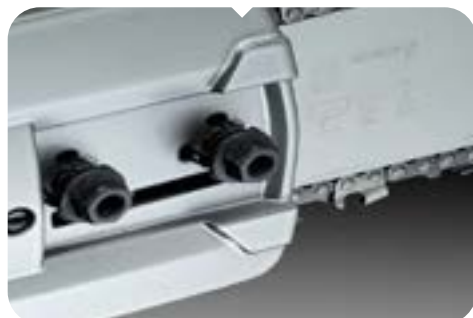
Regulação da tensão lateral da corrente com ferramentas e sistema de porcas de fixação
